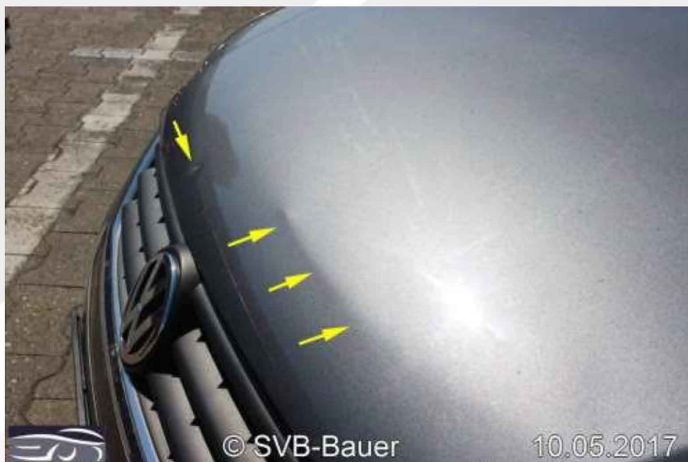
Bild 3: Detailaufnahme Motorhaube im vorderen Bereich geknickt sowie Delle an der Abschlusskante
